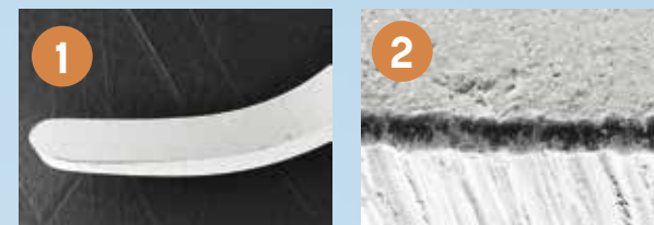
Sharp Diamond -kyretin leikkaava reuna ja sen suurenno kulumistestauksen jälkeen* (Kuvat 1 ja 2)
